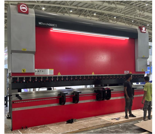
CNC Press Brake (bending) machine: 600-ton x 6 m (August 2024)
